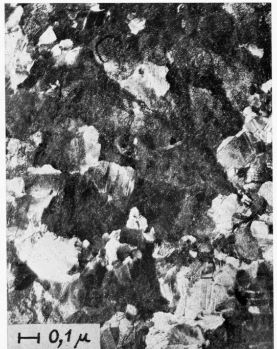
Abb. 7. Wie Abb. 6, aber Kupferträger auf 200° C (Vergr. 60 000 \times ).
