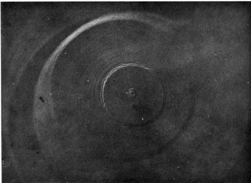
Abb. 3. KCl-Spaltfläche. Durch Wassertröpfchen gelöstes KCl ist in glatten Lamellen wieder auskristallisiert. Stufenhöhe etwa 10–20 Å. Vergrößerung 27 000 \times .
