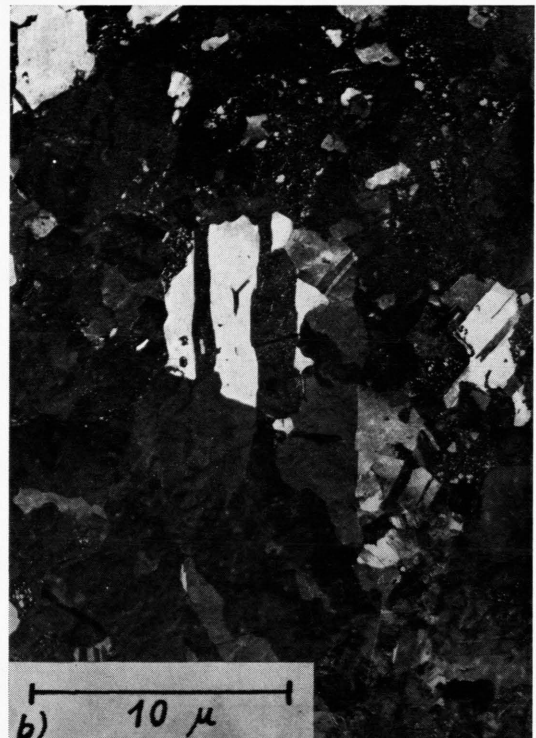
Abb. 8. Vergleich von Hell- (a) und Dunkelfeld (b) einer 200 Å dünnen, auf Kupfer (300° C) aufgedampften Nickelschicht (Vergr. 3500×).
