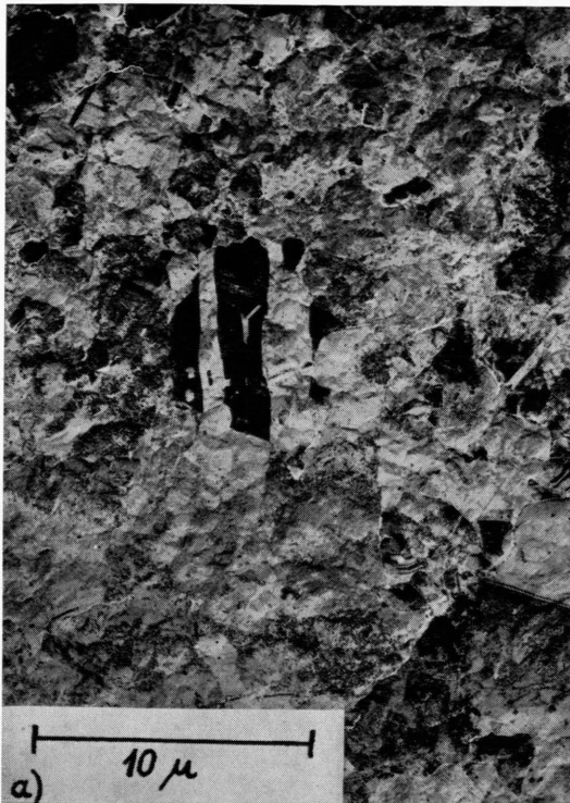
Abb. 8. Vergleich von Hell- (a) und Dunkelfeld (b) einer 200 Å dünnen, auf Kupfer (300° C) aufgedampften Nickelschicht (Vergr. 3500×).
