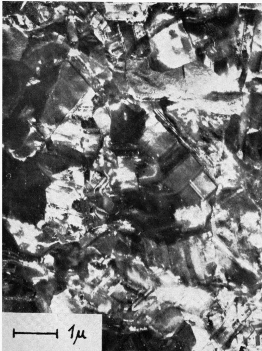
Abb. 2. Elektronenmikroskopische Dunkelfeldaufnahme einer 50 Å dünnen Nickelschicht, welche auf elektrolytisch abgeschiedenem Kupfer niedergeschlagen war (Vergr. 12 000 \times ).
